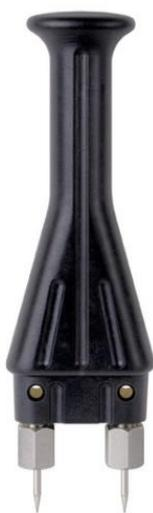
Die Einschlag-Elektrode M 20 besteht aus schlagfestem Kunststoff und ist für Messungen von Holzstärken bis zu 50 mm geeignet (z.B. Schnittholz, Spanplatten, Holzfaserverplatten). Bei Erstausslieferung der Einschlag-Elektrode M 20 sind der Lieferung je 10 Ersatzspitzen mit 16 und 23 mm Länge beigelegt.
