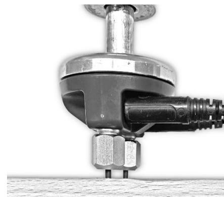
Abbildung 7-3: Verwendung teflonisolierte Spitzen
