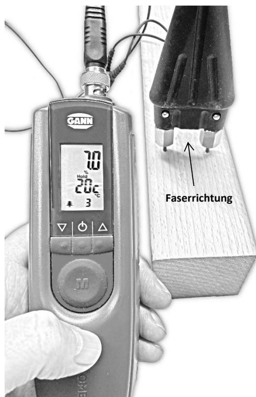
Abbildung 7-1: Holzfeuchtemessung – quer zur Faserrichtung
