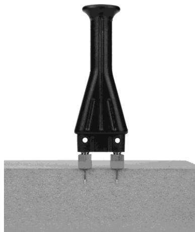
Abbildung 7-2: Holzfaserdämmstoff Elektrode auf Elektrode M 20
