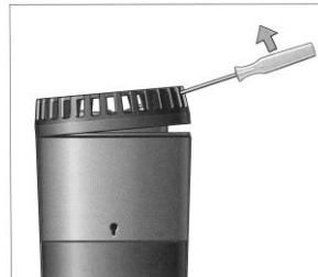
Nettoyez, avec un jet d'eau puissant; la crêpine, la turbine et le carter de pompe. Ré emboîte la crêpine sur le carter de la pompe.
