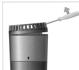
Reinigen Sie mit einem kräftigen Wasserstrahl Saugkorb, Laufrad und Pumpengehäuse. Drücken Sie den Saugkorb wieder auf das Pumpengehäuse bis er einrastet.
