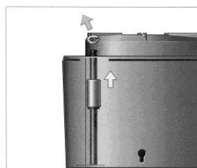
Le flotteur magnétique en matériau moulé est fragile. Manipulez le flotteur avec précaution lorsque vous le (dé) montez et le nettoyez. **Ne dévissez jamais le contact d'alarme pour le nettoyer.**
